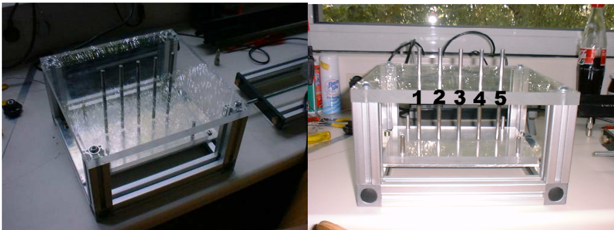
Abb. 4: Vorrichtung für Druckversuche mit Fasern
